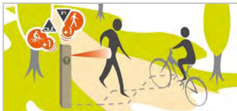
Abbildung 8: Eco-combo Zählsystem von Eco-counter mit Pyrosensoren (im Pfosten) für den Fussverkehr und Induktionsschleifen für den Fahrradverkehr (Eco-counter, 2012)
