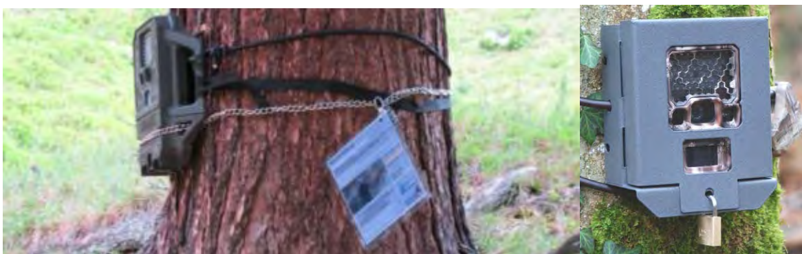
Abbildung 10: links: Automatische Fotokamera im Einsatz (Wildtierkamera Typ Reconyx RC55); rechts: Kamera mit Bewegungsauslöser Reconyx HC600 (Foto: M.Wyittenbach)
